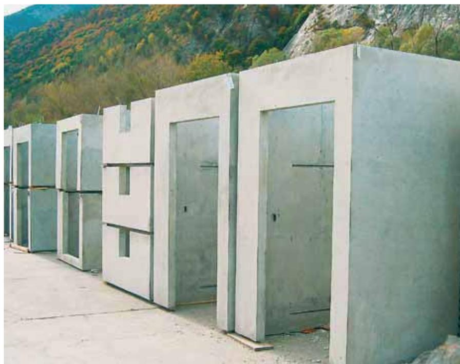
Большая высота опалубки тоже может быть достигнута одной захваткой без стыков.
