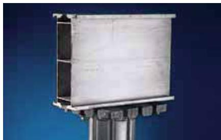
В опорной системе алюминиевого каркаса ГАСС в качестве основной балки применяется алюминиевая балка высотой 22,5 см. Ее статические параметры (допустимое поперечное усилие, допустимый изгибающий момент, момент инерции) согласованы со всей системой. Для самых различных требований, предъявляемых на стройплощадке, предлагаются балки длиной от 1,80 м до 7,20 м.
