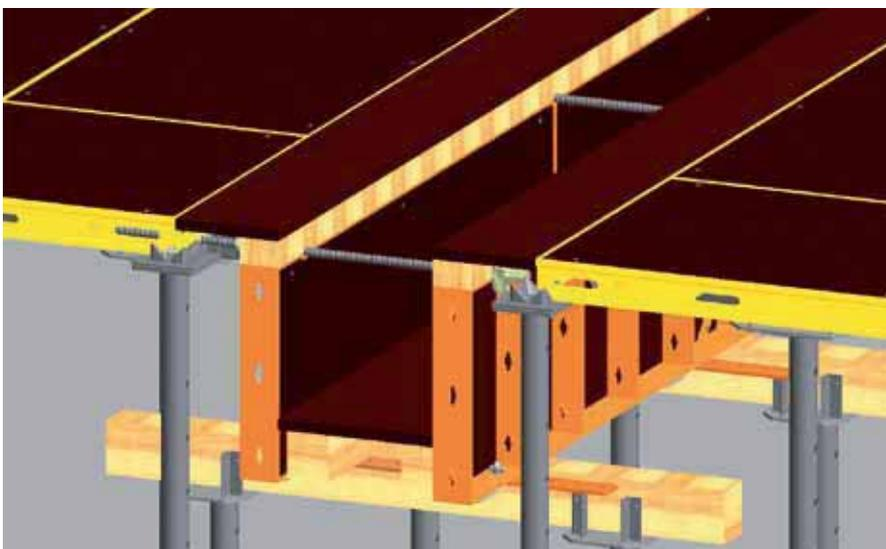
*Возможность использования системно в качестве потолочной балки вместе с опалубкой Растер.*
