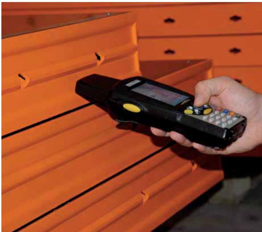
Считывающее устройство при выводе данных об элементе опалубки на экран.
