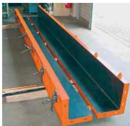
Два угловых узла колонны соединены между собой с помощью шарнира.
