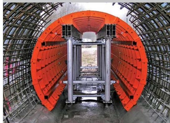
Coffrage pour buse, pliable avec étaieement GASS
