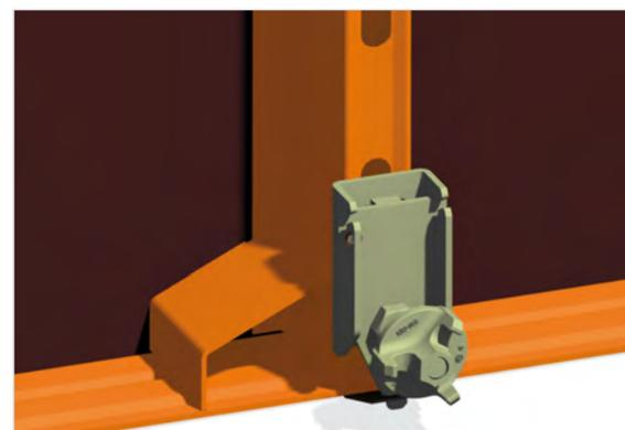
*Après avoir fixé la bande perforée, il faut la serrer en tournant l'écrou jusqu'à ce que la pièce de serrage soit en contact.*
