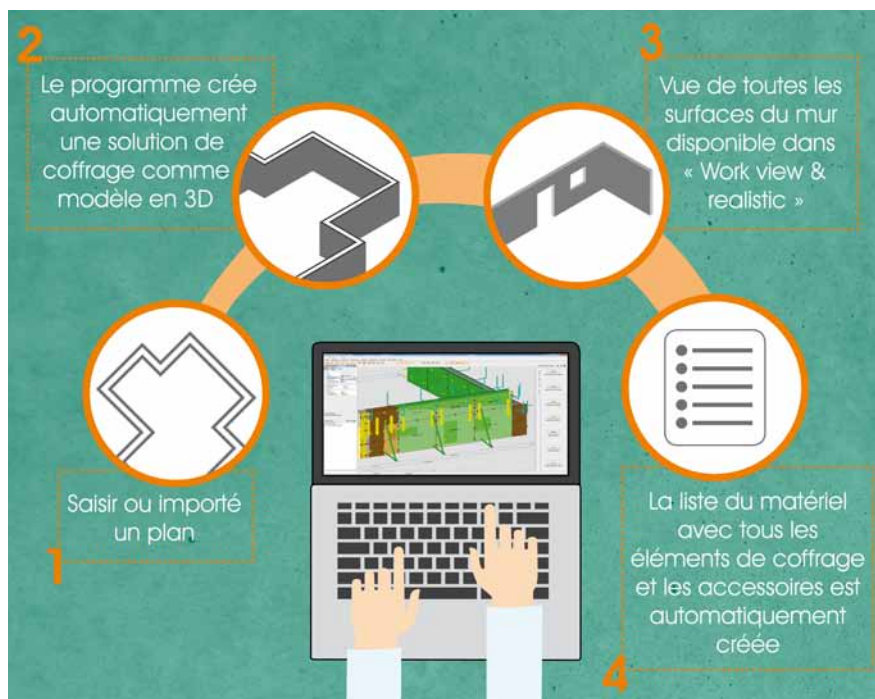
La planification du coffrage peut être affichée, émise, calculée et suivie par sections de travaux et par cycles. Cela permet aux responsables des préparatifs et du suivi des travaux de toujours garder une vue d'ensemble sur chaque projet.
