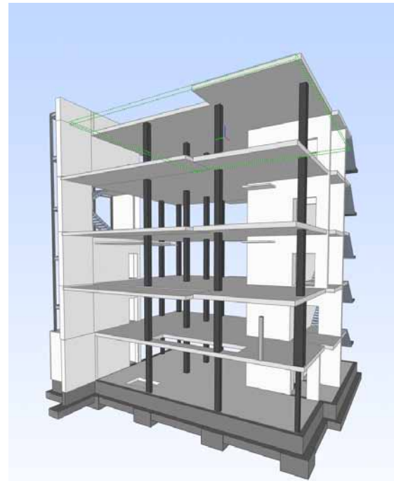
Le logiciel de coffrage entièrement automatique PPL 11.0 lit via l'interface IFC intégrée les données BIM et génère la planification complète du coffrage idéale.
