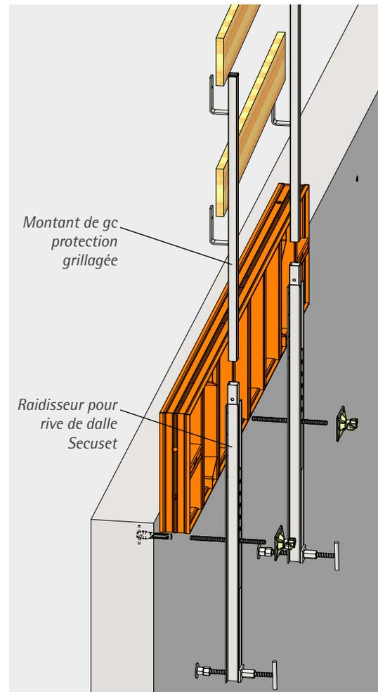
L'ancrage du raidisseur pour rive de dalle Secuset dans le mur avec douille d'induit bétonnée, tige filetée et contre-plaque à rotule.
