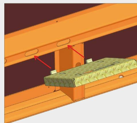
*Pour le montage, le marche pied est légèrement incliné de manière à pouvoir enfoncer les crochets de fixation dans les trous oblongs des profilés transversaux des éléments.*
