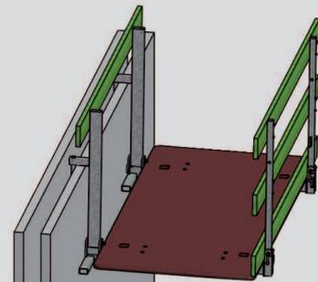
La plateforme de bétonnage offre une variante rapide et économique pour la création d'un poste de travail sûr d'une largeur de 1,10 m et d'une longueur de 2,40 m.
