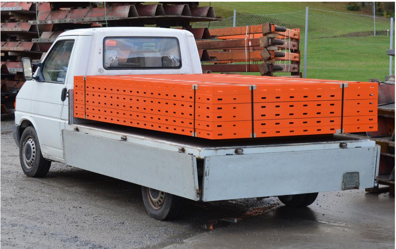
*Durch das geringe Gewicht und die idealen Produktabmessungen lassen sich bis zu 6 Großflächenelemente (1.116 kg) mit einem Pritschenwagen transportieren.*
