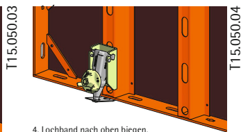
4. Lochband nach oben biegen, bis das Klemmteil im Loch steckt. Mutter drehen, bis das Klemmteil am Lochrand anliegt und das Lochband gespannt ist.
