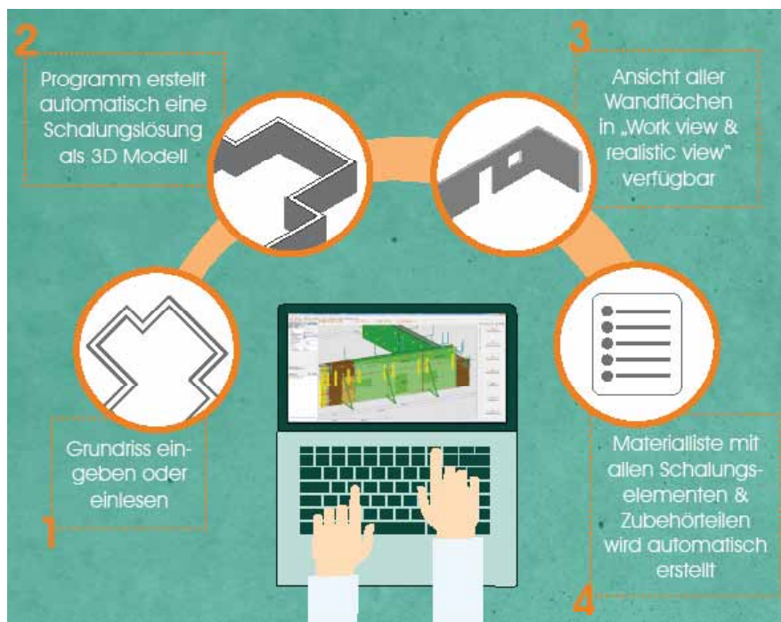
Die Schalungsplanung lässt sich bauabschnittsweise und taktweise anzeigen, ausgeben, berechnen und nachverfolgen. Damit behält die Arbeitsvorbereitung und die Bauleitung stets den Überblick je Bauprojekt.
