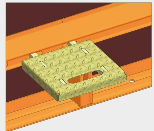
Danach wird das Podest nach unten geklappt und bietet einen sicheren Auftritt.
