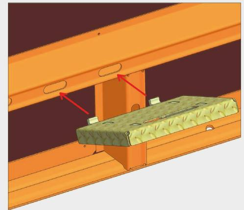
Zur Montage wird das Podest leicht geneigt, sodass die Einhängebügel in die Langlöcher der Elementquerprofile gesteckt werden können.
