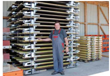
Die Betonierbühnen können für Transporte oder Lagerung platz sparend zusammen geklappt werden.
