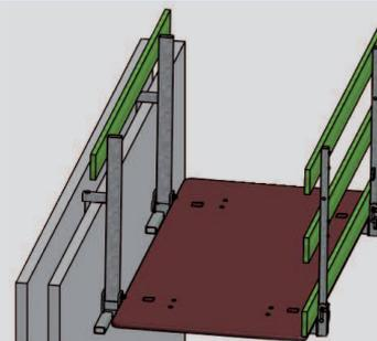
Die Betonierbühne bietet eine schnelle, wirtschaftlichere Variante für das Herstellen eines sicheren Arbeitsplatzes mit einer Breite von 1,10 m und einer Länge von 2,40 m.
