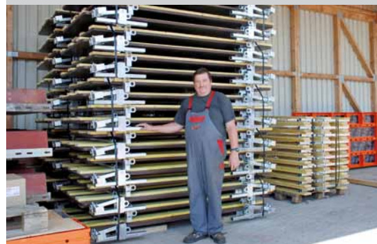
Рабочие площадки могут складываться тем самым экономить место при транспортировке или складировании.
