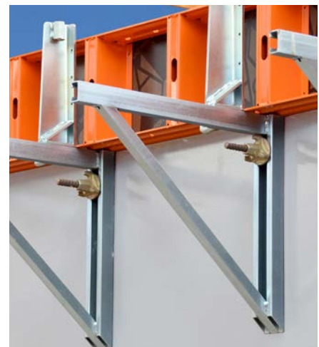
Die Befestigung an der Wand erfolgt über Einbauhülsen mit Schrauben oder Spannstäben DW15.
