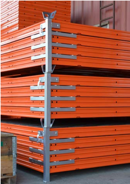
Für ein Gehänge oder einen Stapel werden vier Transport- und Stapelwinkel mit Sicherungsbolzen und zwölf Ecklager benötigt
