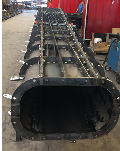
Konische Stütze mit ovalem Querschnitt
