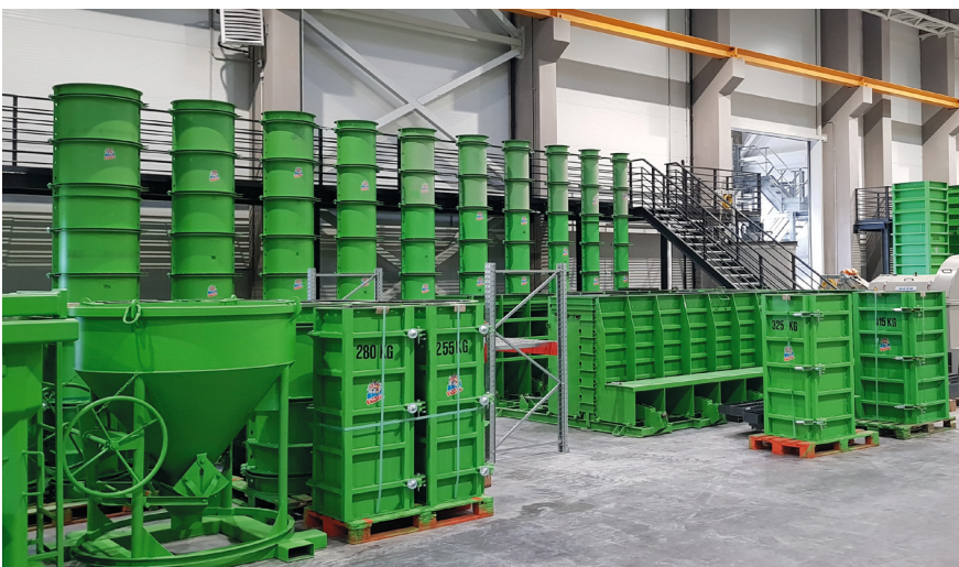
Sonderstützenschalungen in verschiedenen Querschnitten als Grundausstattung für ein Fertigteilwerk
