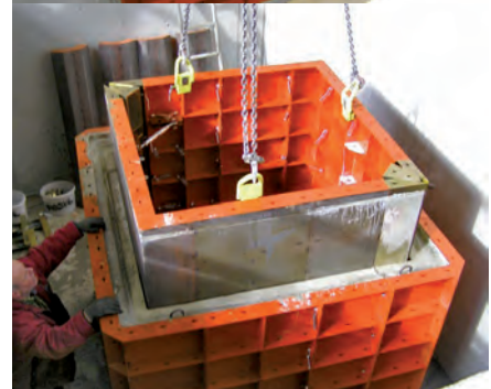
Coffrage avec peau métallique pour puits et regards avec module de tête/pied pour rehausser
