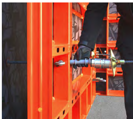
Pour le serrage unilatéral, la tige avec le tube, la douille de guidage et la contre-plaque à rotule sont vissés dans l'unité de serrage du coffrage extérieur.
