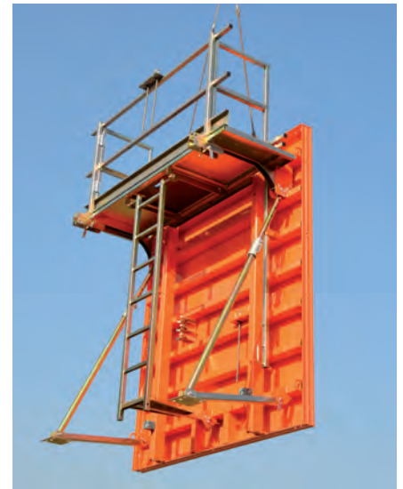
Coffrage de voile LOGO.S avec peau métallique Système de grande surface pour immeubles commerciaux et résidentiels, construction industrielle, génie civil, construction de bassin.
