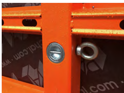
L'unité de serrage forme une surface plane avec le cadre de l'élément.
