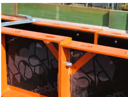
Les trous oblongs intégrés dans le cadre de l'élément permettent un décalage en hauteur allant jusqu'à 2 cm pour les surfaces d'installation inégales.
