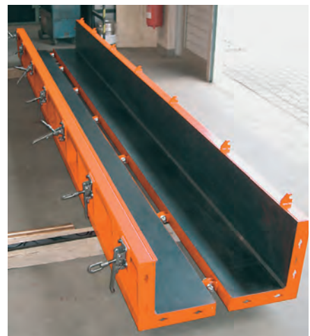
Deux éléments d'angle d'un coffrage pour poteaux sont reliés l'un à l'autre par une articulation.
