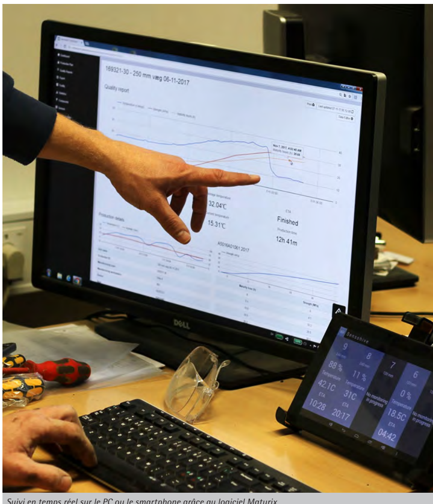
Suivi en temps réel sur le PC ou le smartphone grâce au logiciel Maturix.
