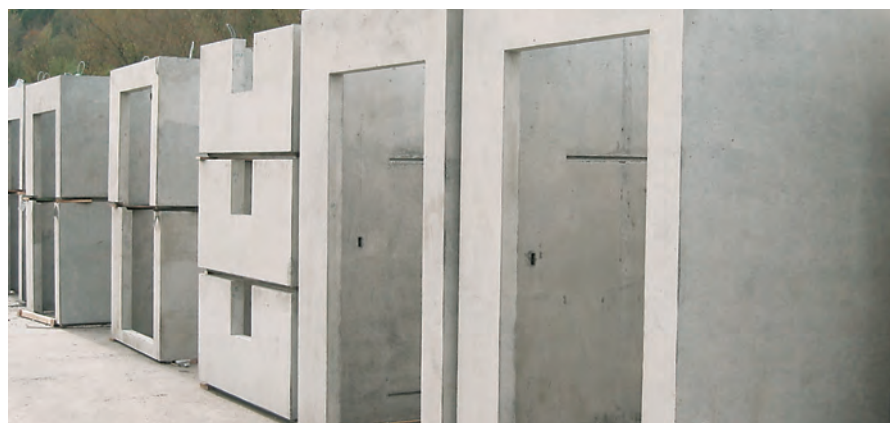
Différentes tailles peuvent être réalisées avec un seul coffrage.
