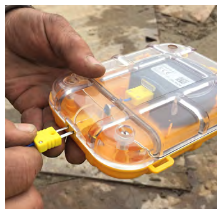
Le câble-capteur est monté directement sur l'armature et connecté à l'émetteur radio.
