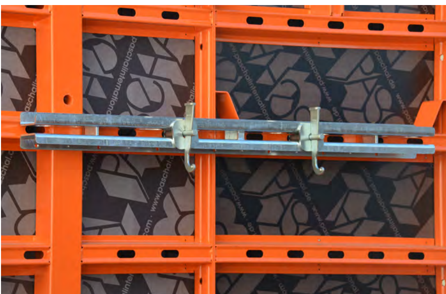
Système de filière - Le système de filière multi est ici utilisé en combinaison avec des éléments de serrage LOGO (10 cm). Autre possibilité : l'utilisation d'un support pour filière ou d'un boulon tête marteau.
