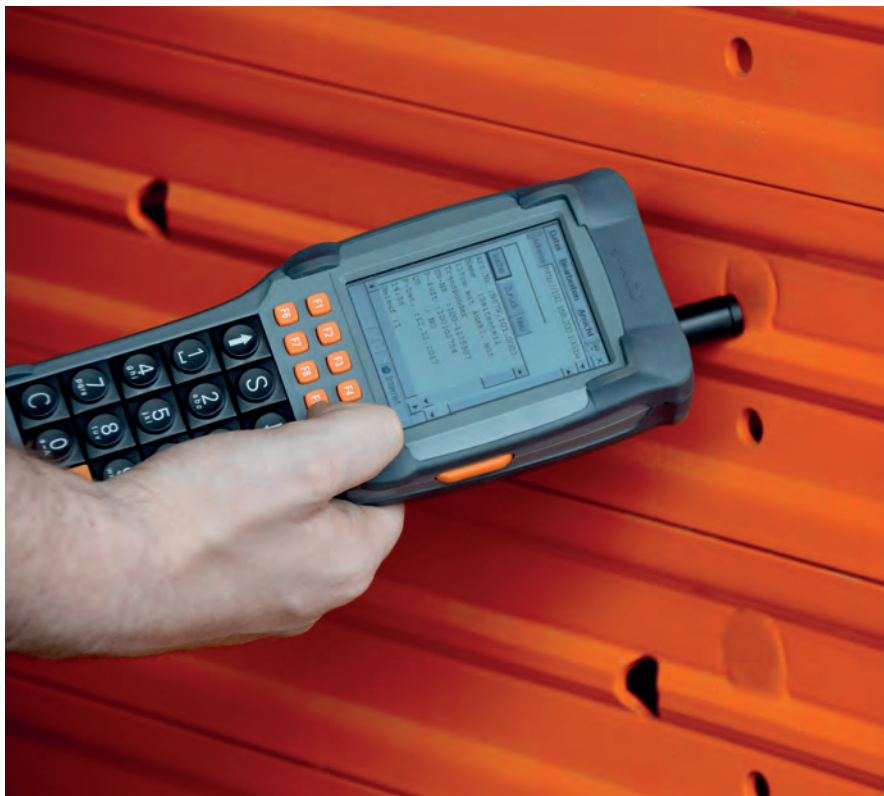
L'appareil de lecture communique avec le transpondeur
