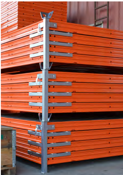
Pour une suspension ou une pile, quatre angles de transport et d'empilage sont nécessaires avec des boulons de sécurité et douze piliers d'angle.
