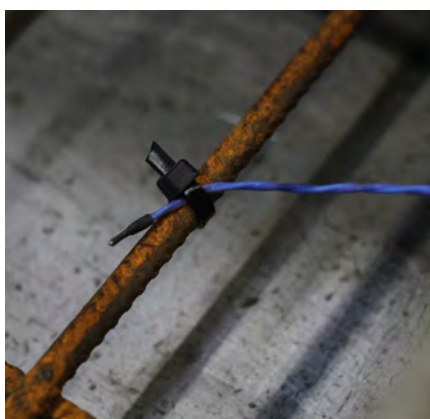
Le câble-capteur est monté directement sur l'armature et connecté à l'émetteur radio.
