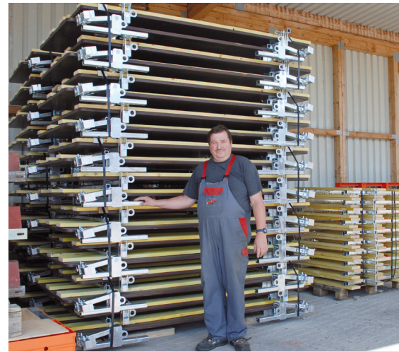
Les plateformes de bétonnage peuvent être repliées lors du transport ou du stockage pour un gain de place.
