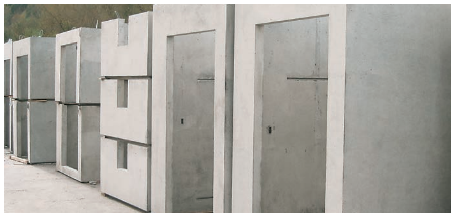
Mit einer einzigen Schalung können unterschiedliche Größen hergestellt werden.
