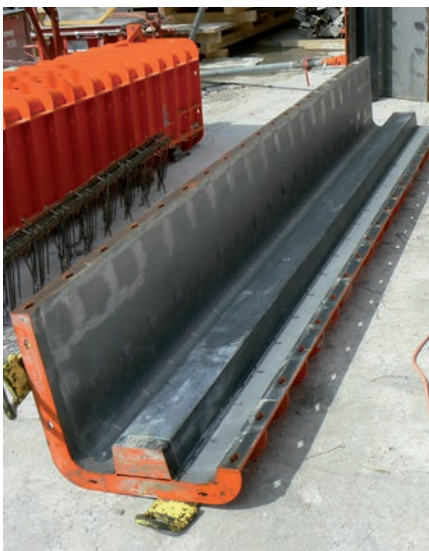
Sonderstützenschalungen in verschiedenen Querschnitten für PREbeton Zrt., HUN-Erdőtelek
