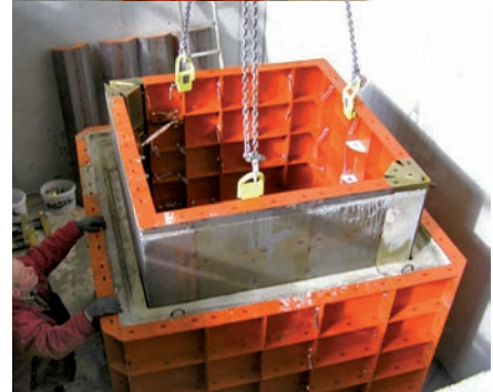
Spannstellenlose Stahl-Schalung für Schächte und Lichtschächte mit Kopf- und Fußform zum Aufstocken.
