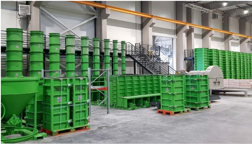
Sonderstützenschalungen in verschiedenen Querschnitten für PREbeton Zrt., HUN-Erdőtelek
