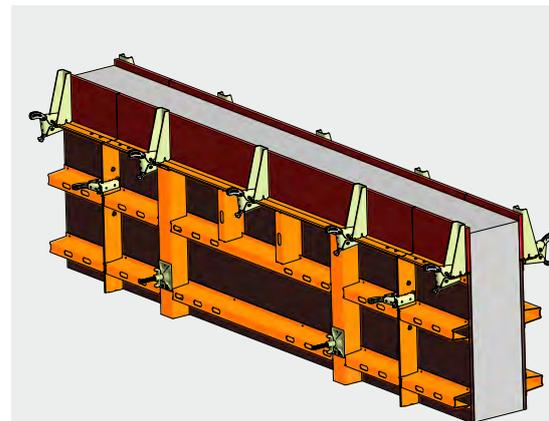
Wenn kleine Elementbreiten (liegend eingesetzt) nicht ausreichend zur Verfügung stehen, können Aufstockungen mit dem Aufstockwinkel realisiert werden.
